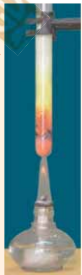
Hình 2.20. Thí nghiệm sắt tác dụng với lưu huỳnh
