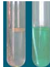
Hình 2.7. 1 - Đồng phản ứng với dd \text{AgNO}_3 2 - Bạc không phản ứng với dd \text{CuSO}_4
