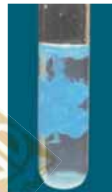
Hình 1.22. Dung dịch \text{CuSO}_4 tác dụng với dung dịch \text{NaOH}
