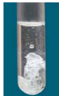
Hình 1.9. Nhôm tác dụng với dung dịch axit
